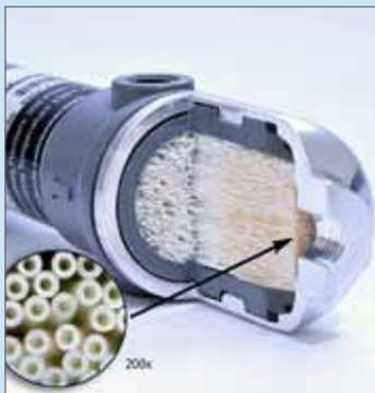
一般的なメンブレンセパレーターの内部には数千本の中空糸の束があり、中空糸束の両端はエポキシ樹脂で固められています。この束の両端は切断され、中空糸の穴が両端では開いているため、ガスは端から端へ流れることができます。中空糸の束は適切なケーシングに収容されています。ケーシングは、中空糸を保護して、ガスを適切に送ります。
