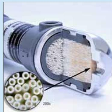
一般的なメンブレンセパレーターの内部には数千本の中空糸の束があり、中空糸束の両端はエポキシ樹脂で固められています。この束の両端は切断され、中空糸の穴が両端では開いているため、ガスは端から端へ流れることができます。中空糸の束は適切なケーシングに収容されています。ケーシングは、中空糸を保護して、ガスを適切に送ります。
